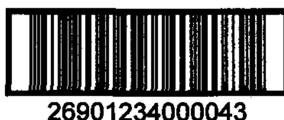
图 C.4 包装指示符为“2”的 ITF-14 条码示例
